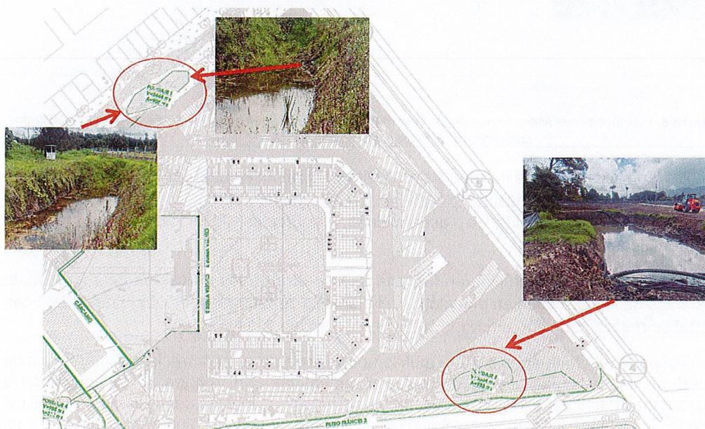
Figura 5. Sistema de SUDS en la zona de gradas y planta, adaptado con registro de inspección ocular del 18\_07\_2025.
